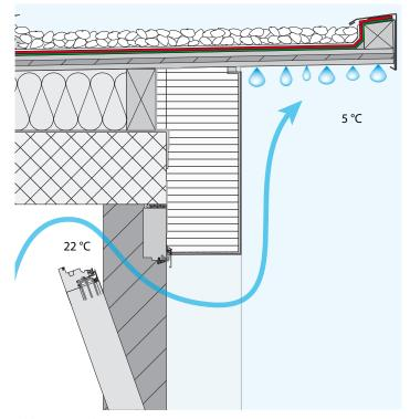
Abb. 7: **Ursache 2**Infolge offener Fenster direkt unter dem Vordach kondensiert die Feuchtigkeit der aufsteigenden warmen Luft an der kalten Unterseite der Holzplatte.
